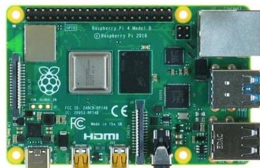
Figure 3. Raspberry Pi4 Model B
